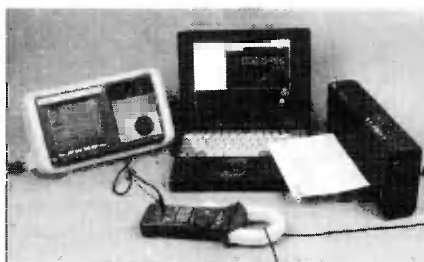
Рис. 9. Подключение АСК-2023 к компьютеру и принтеру для обработки результатов измерений
